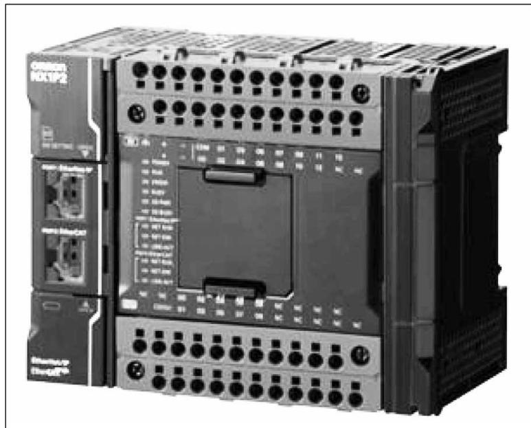
Nota: La imagen muestra el controlador programable compacto modelo NX1P2 propuesto para el control automatizado de la banda transportadora. Fuente: OMRON Corporation (2023b).
