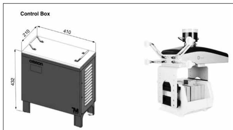
Nota: Dimensiones de la cámara, caja de control de robot colaborativo (*cobot*) y la pinza (herramienta) para el robot colaborativo (*cobot*). Fuente: OMRON Corporation (2023).
