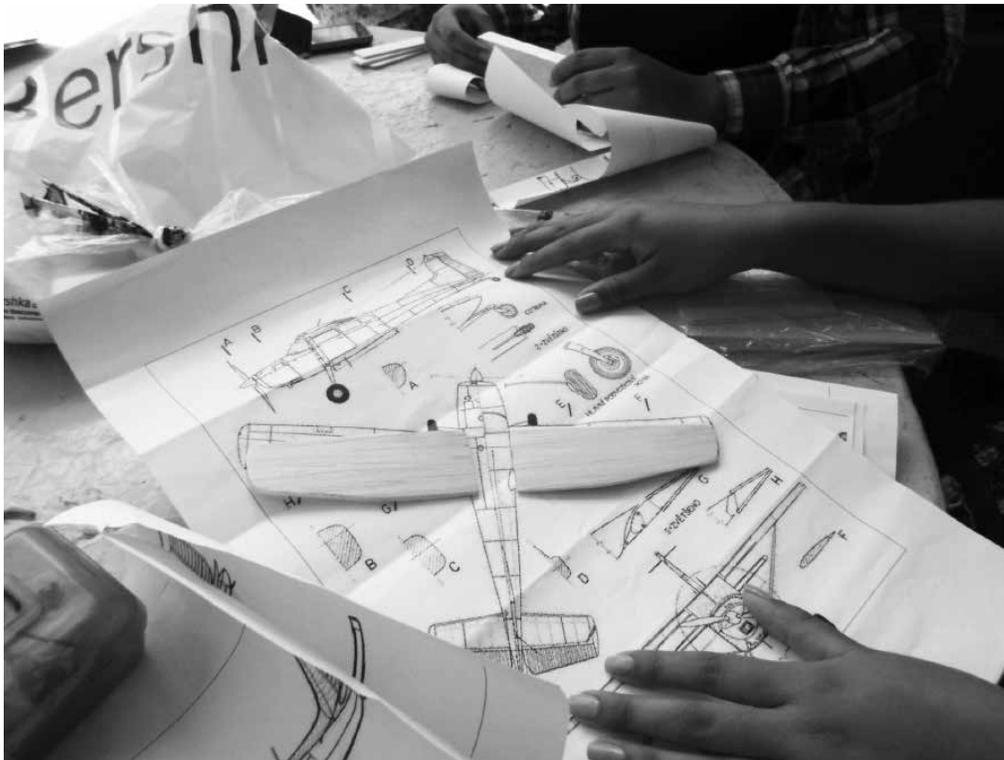
Nota: En la fotografía se observa el corte de piezas en madera balsa tomando como patrón la impresión del diseño computarizado a escala.
